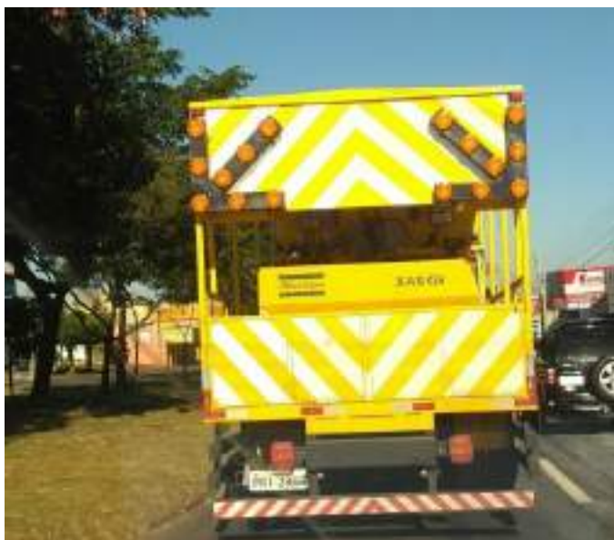
Figura 04 - Modelo de painel tipo seta
