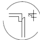
CORTE GAVETAS SEM PUXADOR - COM DETALHE EM CAVA NA PRÓPRIA MADEIRA NA PARTE SUPERIOR
